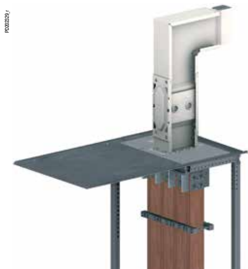
Глубина шкафа в зависимости от номинала шинопровода
