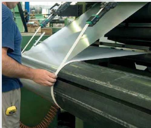
Намотка обмотки низкого напряжения
