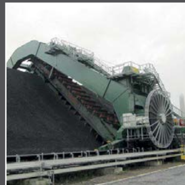
Приводной кабельный барабан на мостовом реклеймере, США
