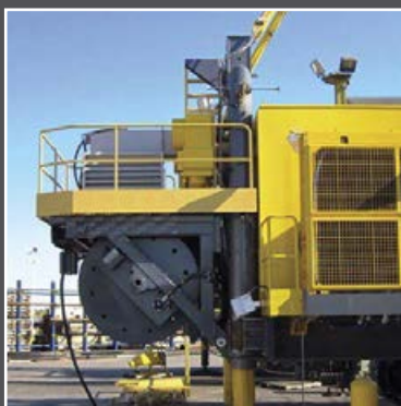
Приводной кабельный барабан на буровом станке, США
