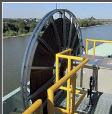
Приводной кабельный барабан на корабельном загрузчике США
