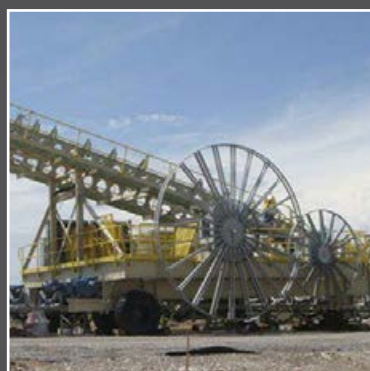
Приводные кабельные барабаны на радиальном стакере, Великобритания
