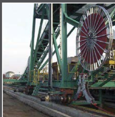
Приводной кабельный барабан На Стакере/Реклеймере, Тайланд
