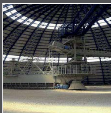
Подвесная система На круговом мостовом реклаймере, США
