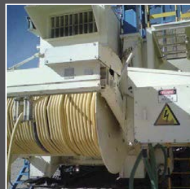
Приводной кабельный барабан на буровом станке, Чили
