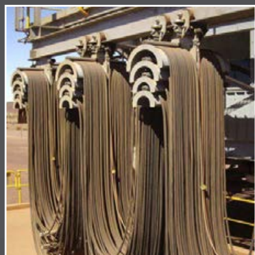
Подвесная система на вагонопрокидывателе, Австралия
