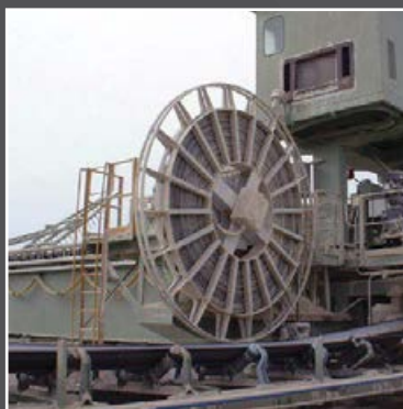
Барабан рядной намотки на стакере-реклеимере, США
