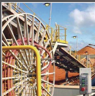
Приводной кабельный барaban, Австралия
