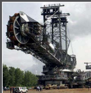
Приводной кабельный барабан на Роторном Экскаваторе, Германия
