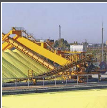
Приводной кабельный барабан на портальном сткере, Россия
