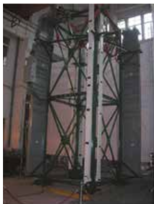
Вертикальные испытания на сейсмическую стойкость
