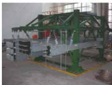
Горизонтальные испытания на сейсмическую стойкость
