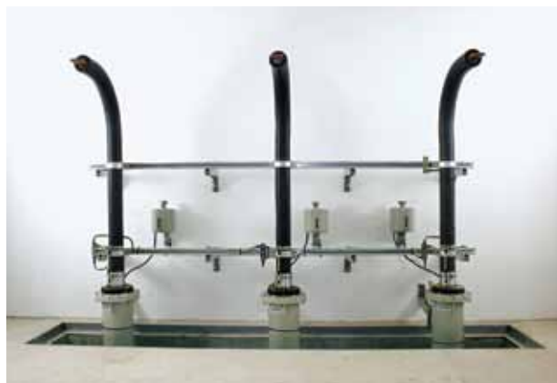
DURESCA 123 кВ 2500 А (Испытательная лаборатория, Хорватия)
